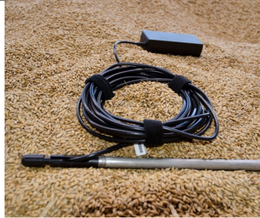
Figur 6. Stackview trådløs temperatursensor. Der er kabel mellem spyddet og senderen.
