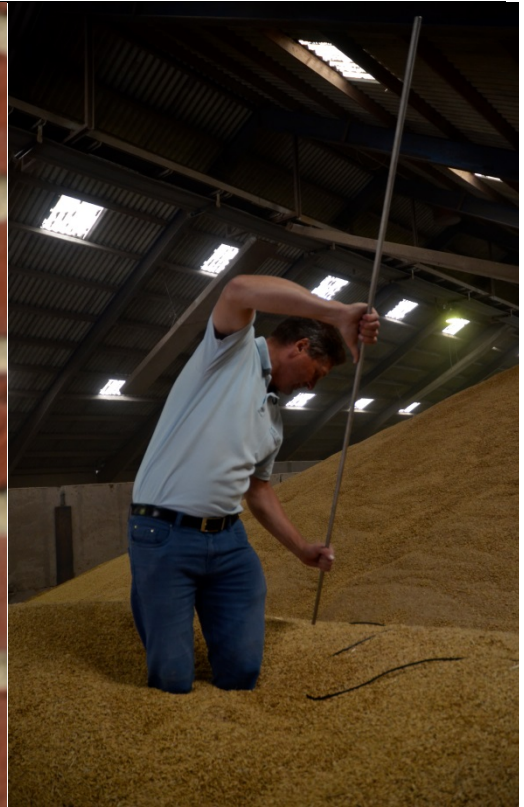
Figur 5. Stackview sensor stikkes ned i korndyngede ved hjælp af "harpun" (lang, slank metalstang).
